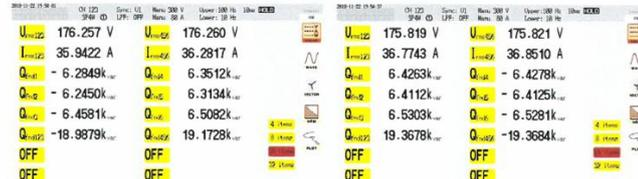
图 9.1 感性负载 80%Un 电压等级无功补偿功率测量
